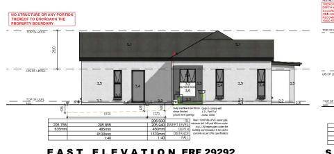
EAST ELEVATION ERF 29292 SCALE 1:100
